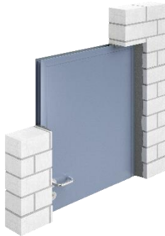
Vermörteln von Brandschutztüren
