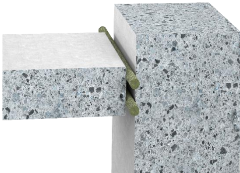
Einbau Scherfuge zwischen Wand und Decke
