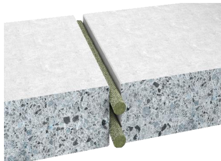
Zweilagiger Einbau in Scherfugen für EI 90
