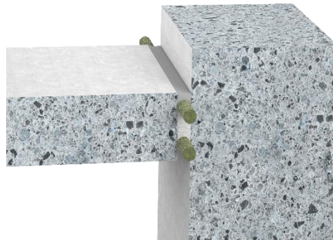
Einbau Scherfuge zwischen Wand und Decke mit brennbarer Füllung und Versiegelung
